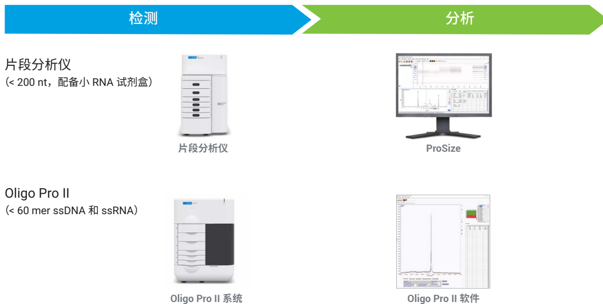
工作流程 1：通过毛细管电泳进行核酸（短链）分析
